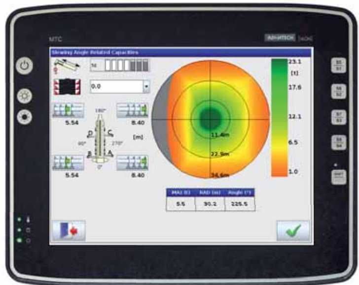
Simulación de planificación a bordo con el sistema de control IC-1 Plus
