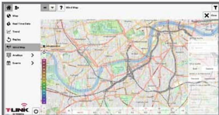
**T-Link** consente di visualizzare le gru sulla mappa secondo una visione standard o satellitare. Seleziona facilmente la gru che ti interessa o visualizza più gru impiegate nello stesso sito. Sulla mappa viene visualizzato lo stato della gru: non in linea, in attesa, in funzione, in stato di allarme, spenta. Selezionando una gru è possibile accedere ai suoi dati in tempo quasi reale.
