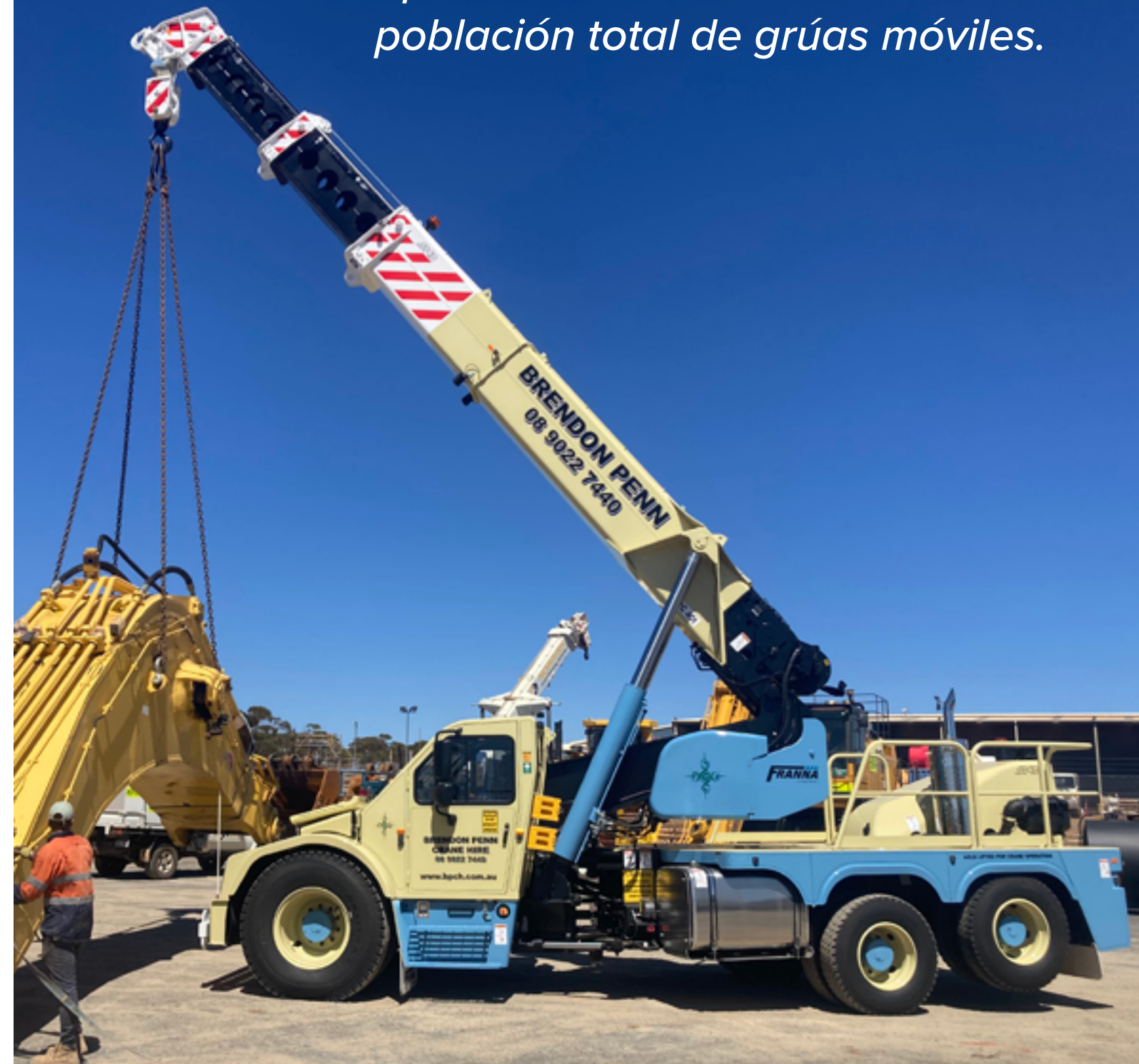
Pluma de elevación AT 40 de 22 t para una excavadora/pala de minería
