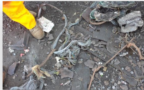
Metallo rimosso dal magnete
