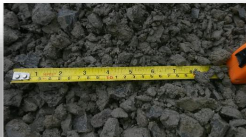
独立型プレスクリーン0~ 32mm (高い粘土含有量)
