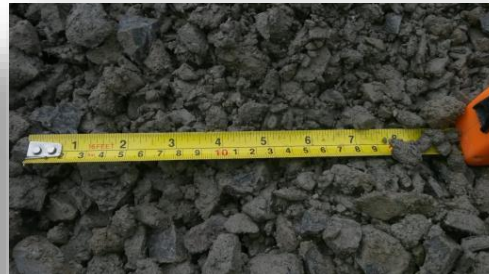
Unabhängiges Vorsieb 0-32 mm (mit hohem Lehmgehalt)
