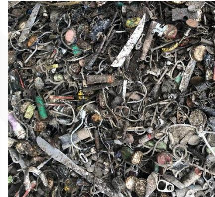
Vom Magneten entferntes Material
