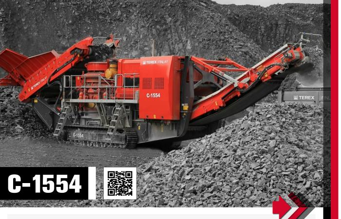
Le concasseur giratoire Terex Finlay C-1554 est la meilleure solution mobile pour tous les producteurs et opérateurs recherchant une machine à forte capacité, offrant un coefficient de réduction élevé et une excellente cubicité.
