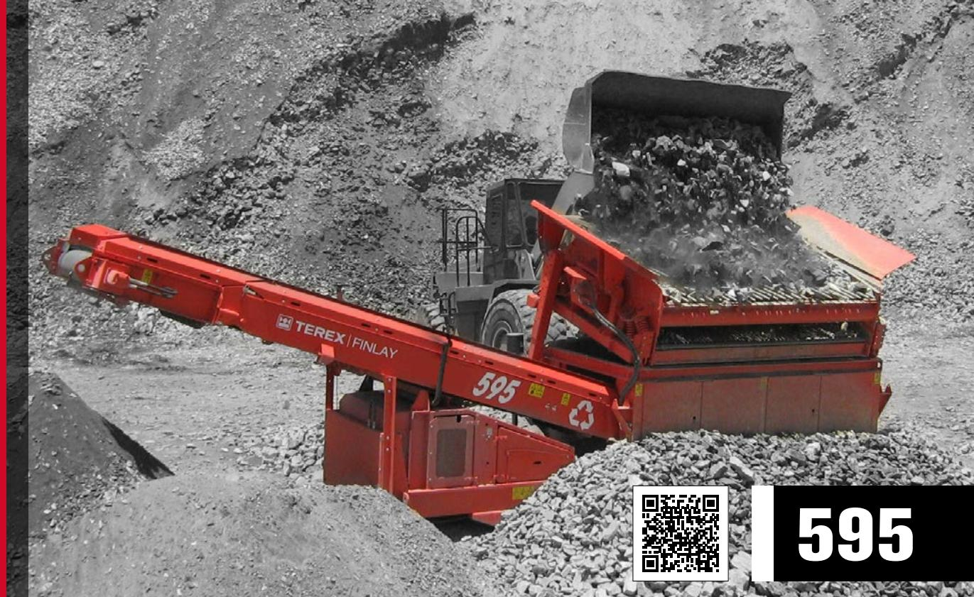
Die Terex® Finlay 595 Hydratrak ist eine eigenständige mobile Vorsiebanlage mit hoher Kapazität. Die nach höchsten Qualitätsmaßstäben entwickelte und hergestellte 595 eignet sich für die härtesten Anforderungen, von der Weiterverarbeitung von Abfällen bis hin zum Einsatz in Steinbrüchen und für Abbrucharbeiten. Zu den besonderen Merkmalen zählen ein Hochleistungs-Zwei-Deck-Vibrationsrost, die Fernsteuerung und das Raupenfahrwerk.
