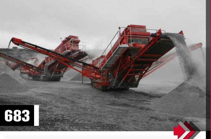
Noto per la sua qualità, le prestazioni e la produttività, il Terex® Finlay 683 combina sgrossatura, vagliatura e stoccaggio in una singola unità semovente.
