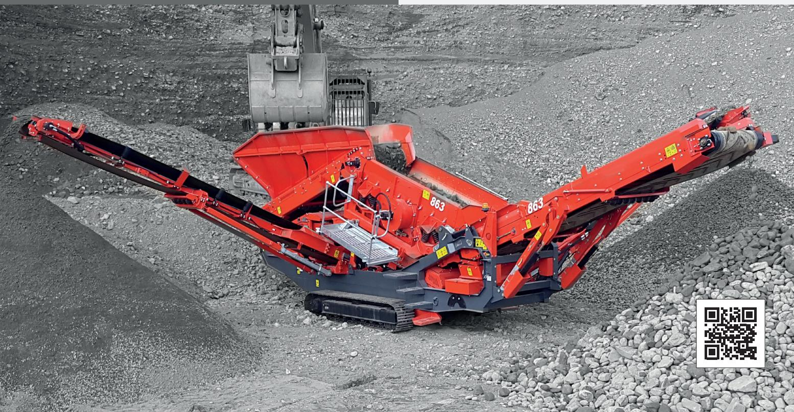
A peneira móvel com esteiras para demanda pesada da Finlay® 863 é uma usina compacta e agressiva virada para frente. Esta usina portátil e flexível autopropelida pode trabalhar com agregados, mineração de superfície, areia e cascalho, camadas superiores do solo e em aplicações de demolições de construções e de reciclagem onde o espaço local for escasso.
