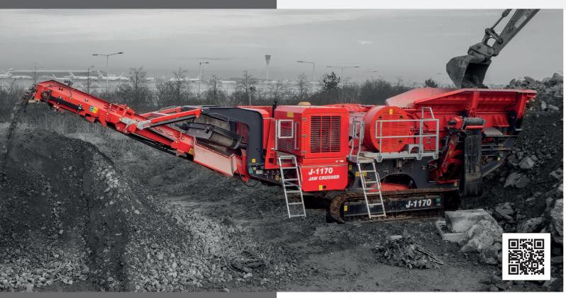
O Finlay® J-1170 é um britador de mandíbulas primário, móvel, com esteiras, compacto e agressivo. O J-1170 possui um transportador de alimentação para serviço pesado e um sistema de pré-peneira integrado que possibilita uma produção ótima em aplicações em pedreiras, mineração, demolição e reciclagem.
