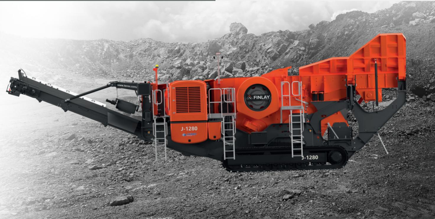
O britador de mandíbula híbrido Finlay® J-1280 oferece aos operadores a flexibilidade de alimentar a máquina através de uma configuração de gerador interno ou conexão a uma fonte de eletricidade. As duas opções de alimentação oferecem aos operadores reduções significativas nos custos de energia, serviço e manutenção em comparação direta com uma máquina a diesel/com alimentação hidráulica.
