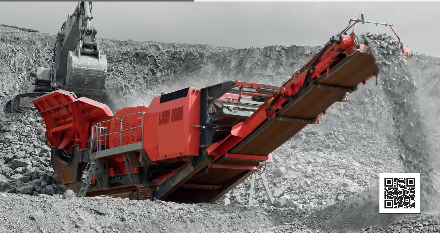
A J-1480 da Finlay® é uma britadeira de garras móvel sobre esteiras autopropelida de alto desempenho. A J-1480 da Terex Finlay incorpora a britadeira de garras Terex® World que fornece uma capacidade de produção de até 750tph dependendo da aplicação e do material.
