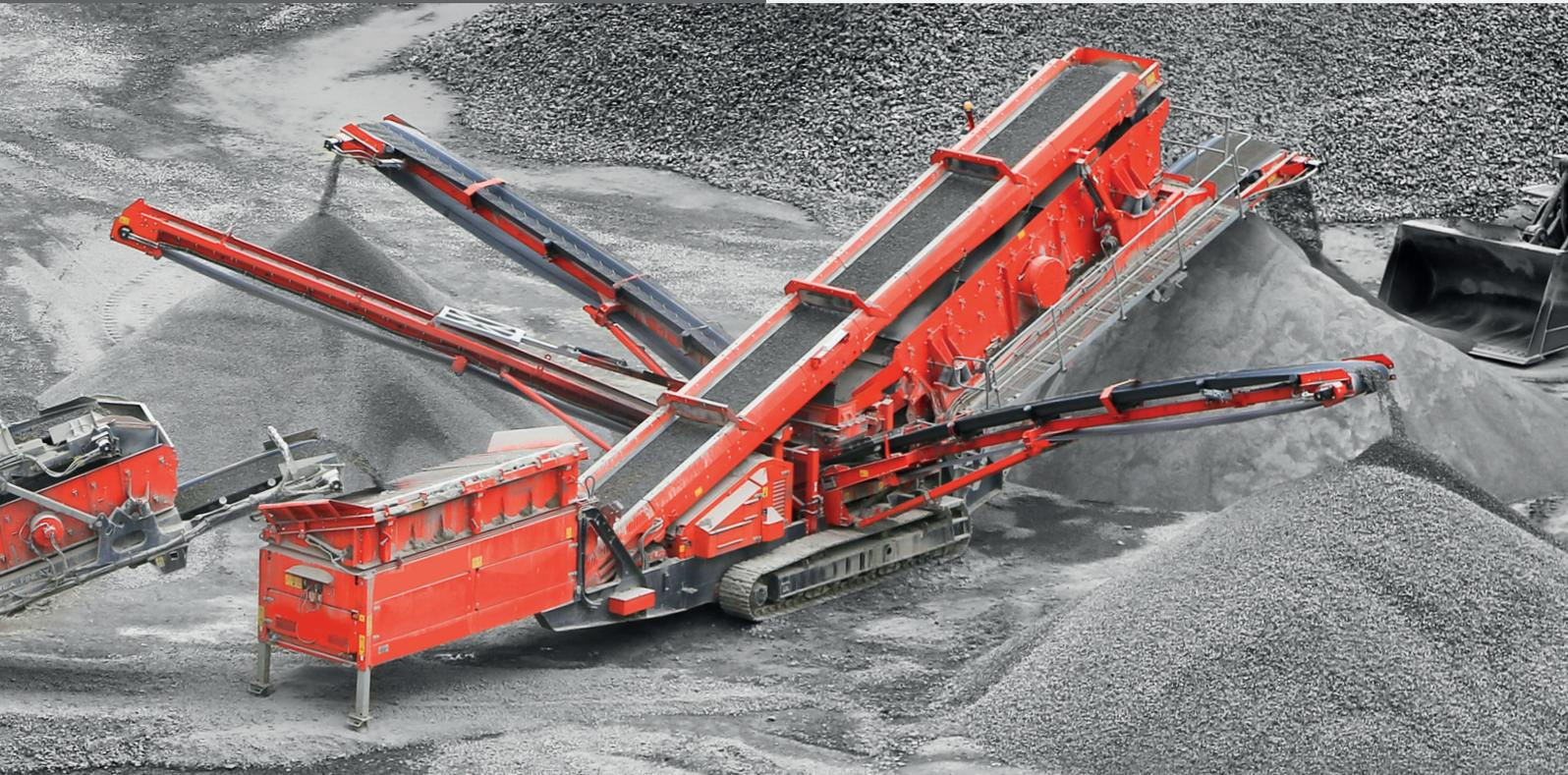
Le crible incliné 696 à 3 étages de Terex Finlay a été conçu pour offrir une solution de production à rendement élevé dans les secteurs des carrières, des mines, du sable, du gravier, du charbon, des copeaux de bois et de la terre végétale.
