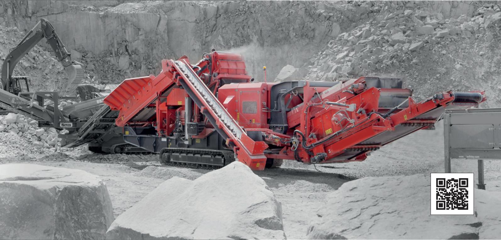
Le concasseur giratoire mobile sur chenilles Finlay® C-1540RS combine le concassage et le criblage en un seul châssis. Basé sur le modèle du concasseur Terex Finlay C-1540, cette variante intègre un système innovant de recirculation embarqué ainsi qu'un crible détachable.
