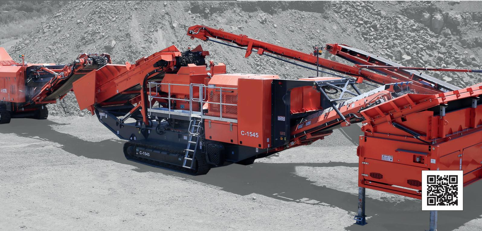
Le C-1545 de Finlay® est un concasseur giratoire puissant de grande capacité fournissant un rendement élevé constant et un produit d'une excellente cubicité. Cette machine efficace et productive intègre le concasseur giratoire 1150 de Terex® avec entraînement à embrayage direct à vitesse variable, relâchement automatique du bol et réglage hydraulique du serrage.
