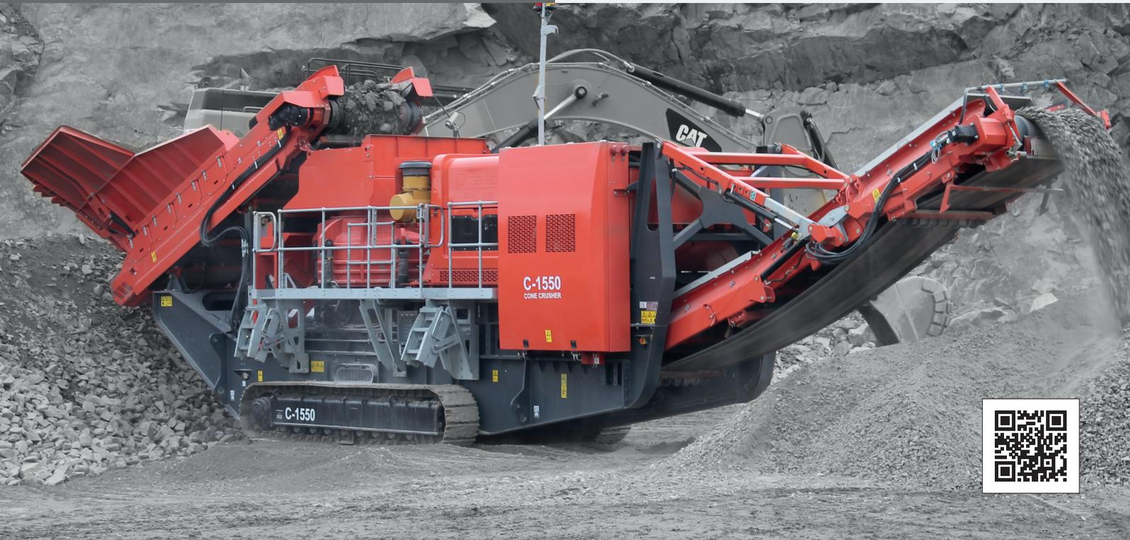
Robuste et ultraperformant, le Finlay® C-1550 est un concasseur giratoire spécialement conçu pour les applications d'agrégats et d'exploitation de carrière. Le concasseur à cône Terex Finlay C-1550 est équipé du Terex® 1300, concasseur giratoire à entraînement variable direct dont la réputation n'est plus à faire.
