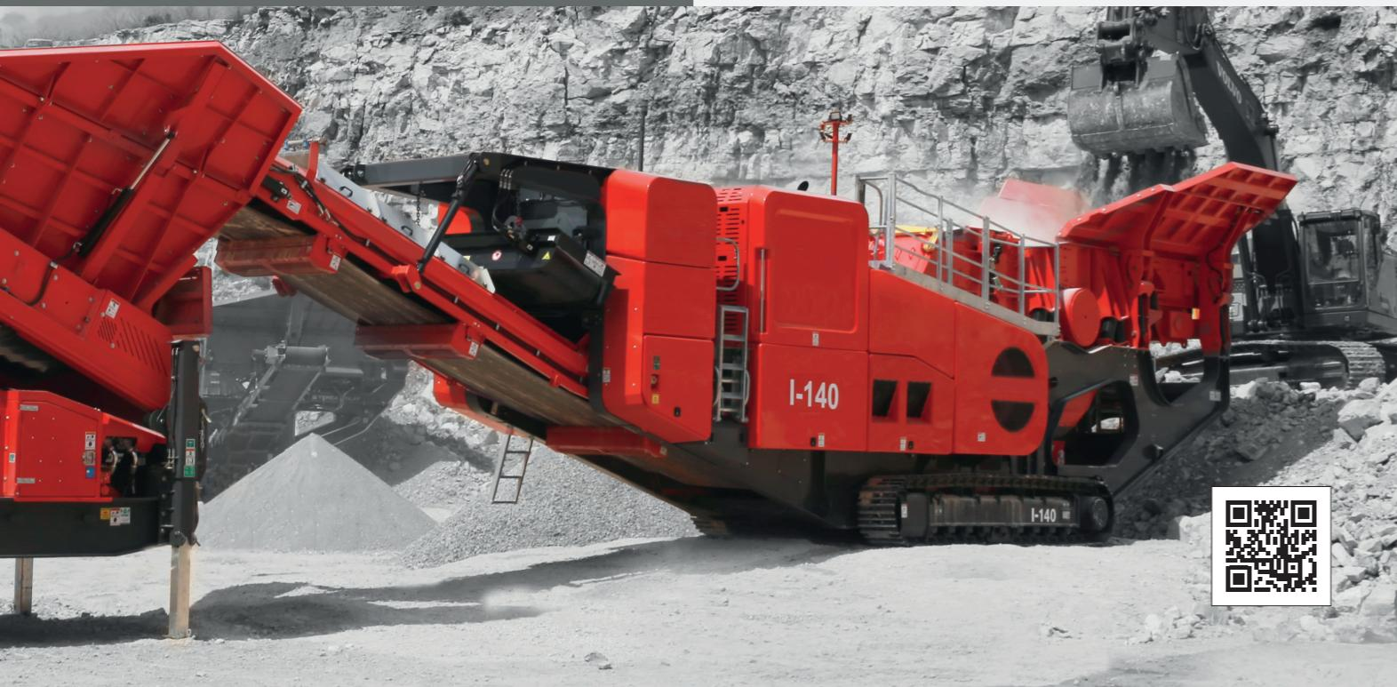
Die Finlay® I140 Brecheranlage gestaltet die Zukunft durch Innovation. Dieser Prallbrecher gehört zur neuen Generation im modernen Design und Technik, optimiertem Materialfluss und besten Produktionskapazitäten, sowohl für die Natursteinaufbereitung als auch für Recycling und Abrucheneinsätze bestens geeignet.
