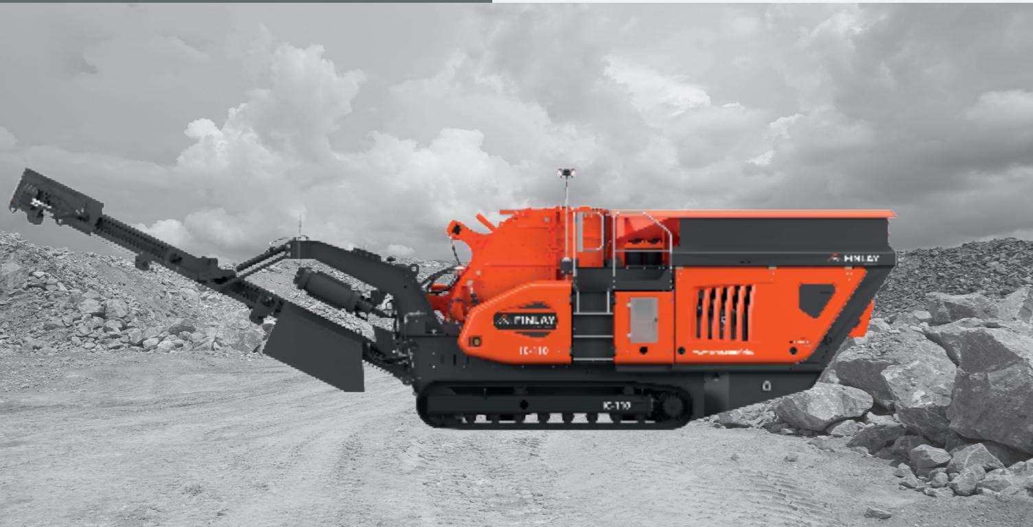
Der IC-110 Kompakt-Prallbrecher ist auf hohe Produktivität bei Steinbrucharbeiten, der Verarbeitung von Bauschutt und Stahlbeton sowie beim Asphalt-Recycling ausgelegt. Die IC-110 verfügt über eine Ø1.034 x 1.000 mm Prallbrecherbox mit Direktantrieb und variabler Rotordrehzahl sowie über eine hydraulische Vorrichtung zur einfachen und effizienten Einstellung der Prallplatten.
