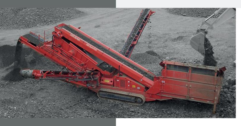
Noto per la sua qualità, le prestazioni e la produttività, il **Finlay**® 683 combina sgrossatura, vagliatura e stoccaggio in una singola unità semovente. Grazie alla struttura robusta, il Terex® Finlay 683, con vaglio da 3,66 m x 1,52 m (12' x 5') può vagliare materiali come sabbia e ghiaia, calcare, pietra frantumata, carbone, terreno di superficie e materiali di risulta di demolizione.
