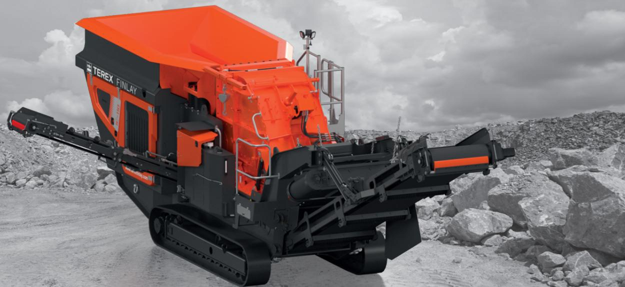
Il frantoio ad urto compatto Terex Finlay IC-100 è stato progettato specificamente per le applicazioni di trattamento di detriti di costruzione, demolizione e frantumazione, riciclaggio di asfalto e cemento armato. Il modello IC-100 è dotato di una camera ad urto orizzontale con trasmissione diretta (diametro 860 mm x 830 mm (Ø34" x 33")) e rotore a velocità variabile.
