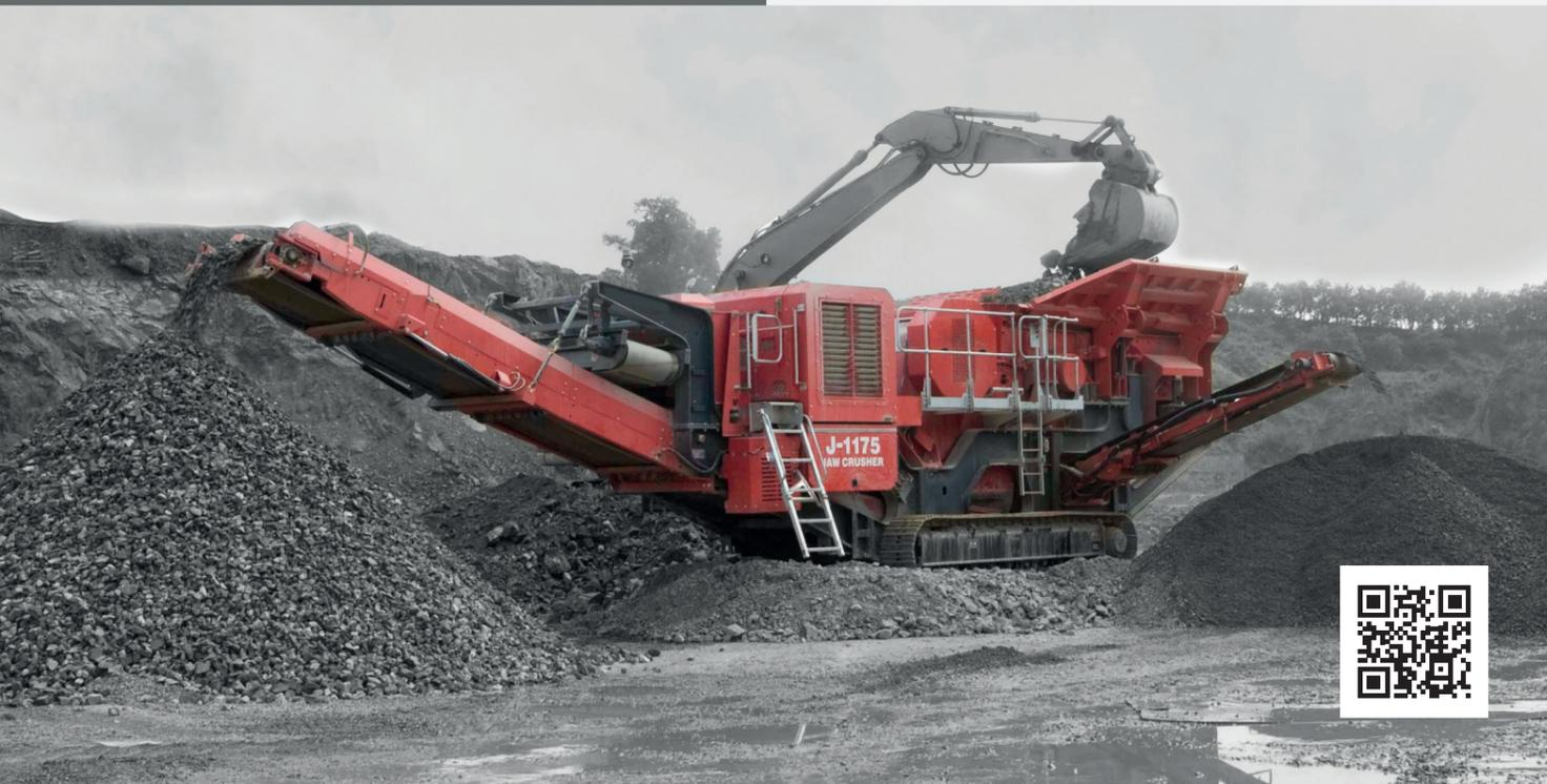
Il frantoio a mascella a doppia alimentazione Finlay® J-1175 offre agli operatori la flessibilità di alimentare l'impianto o tramite l'allacciamento elettrico di rete o con la configurazione della centralina del generatore integrato.
