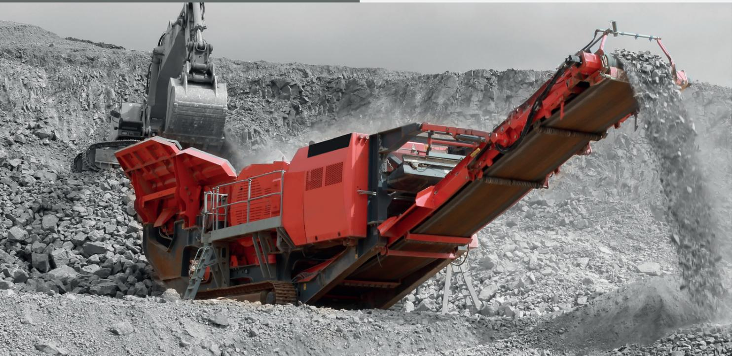
Il Finlay® J-1480 integra il frantoio a mascelle a singolaginocchiera Terex® Jaques JW55, che assicura capacità produttive fino a 700 mt/ora a seconda dell'applicazione e del materiale. La macchina è disponibile con trasmissione diretta per una maggior efficienza nei consumi di carburante e un migliore sfruttamento della potenza disponibile, oppure con trasmissione idrostatica e funzione di marcia indietro per l'eliminazione degli intasamenti e le applicazioni di demolizione.
