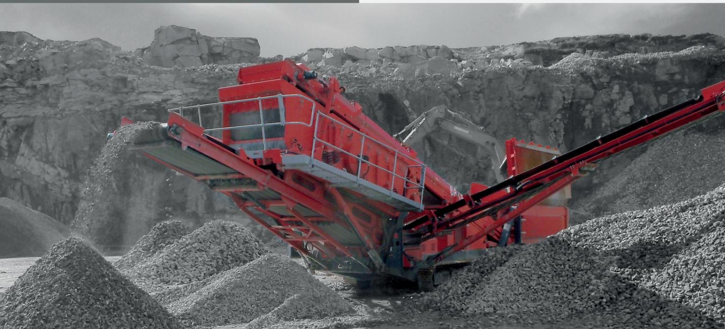
Il modello Finlay® 684 è una macchina compatta e facilmente trasportabile che assicura agli operatori la massima rapidità di configurazione e smontaggio. TIl NUOVO vaglio è dotato di due ampi piani inclinati di 4,3 m x 1,7 m (14' x 5' 7") che offrono una vasta superficie di vagliatura per una maggiore efficienza e una capacità elevata.
