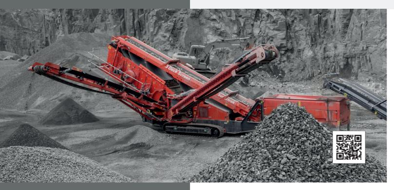
Il modello Finlay® 684 è una macchina compatta e facilmente trasportabile che offre agli operatori la massima rapidità di configurazione e installazione. Il nuovo vaglio del Finlay 684 è dotato di tre ampi piani inclinati da 4,3 m x 1,7 m (14' x 5'7") che offrono una superficie di vagliatura di ben 236 ft2, per garantire una capacità elevata e una vagliatura efficiente.
