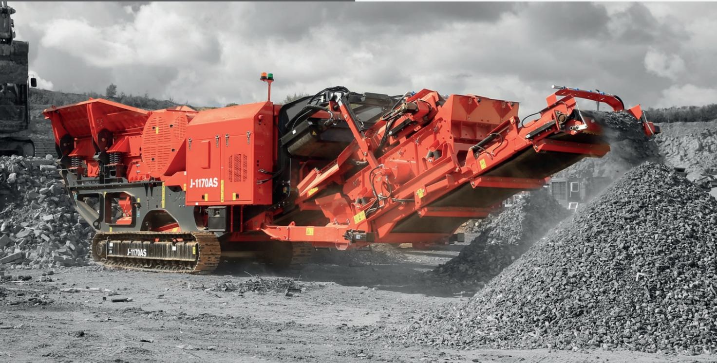
Il frantoio a mascella J-1170AS riunisce la flessibilità di un frantoio e un vaglio in una sola macchina. Questa aggressiva macchina è dotata di un vaglio classificatore staccabile. Il cuore della struttura è una robusta camera a mascella Terex con trasmissione idrostatica che fornisce elevata capacità e ottima riduzione dei materiali.
