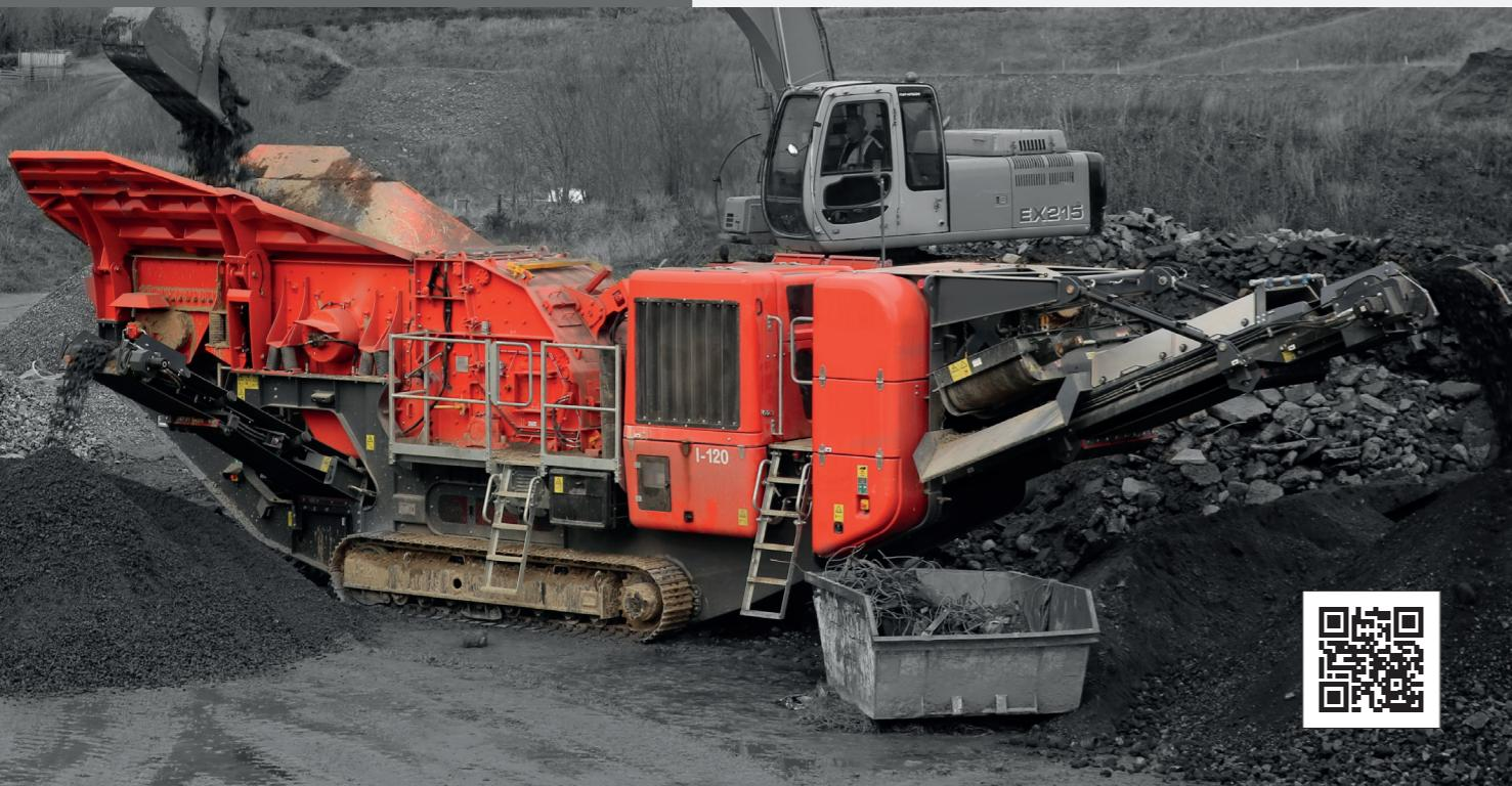
第二世代のI-120インパクトクラッシャーは、採石、採鉱、リサイクル、および建築物解体の用途で、資材のフローを改善し、生産性を高めるように設計されています。優れた実績を誇るTerex® CR038インパクトチャンバーには、ダイレクト駆動と高度な電子制御システムが組み合わされているため、破碎比が高いことに加えて生成物の形状も均一です。リサイクルおよび解体作業者のために、本機にはアンダーパンフィーダーとチャンバーセカンダリエプロンの自動調整機能のオプションが用意されています。
