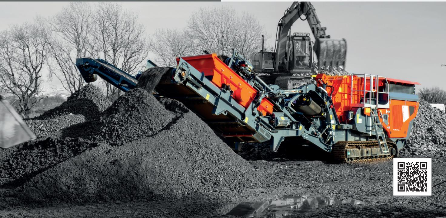
Finlay® IC-100RS インパクトクラッシャーは、建設解体廃棄物の碎石、鉄筋コンクリートやアスファルトのリサイクル用途に最適な単体の可動式プラットフォームにコンパクトな破碎とスクリーニング設備の多様性を実現します。このマシンには、高い燃料効率と生産性を実現するために、可変速度制御を備えたØ860mm x 830mm(Ø34" x 33")のダイレクト駆動水平インパクトクラッシャーが装備されています。主な特長として、2.44m x 1.2m (8' x 4')のオンボードシングルデッキスクリーンがあります。大きすぎる材料を破碎室に戻して再循環させる必要のない場合や、大きすぎる生成物を貯蔵する必要のない場合は、スクリーニング/再循環システム一式を短時間でマシンから取り外すことが可能です。
