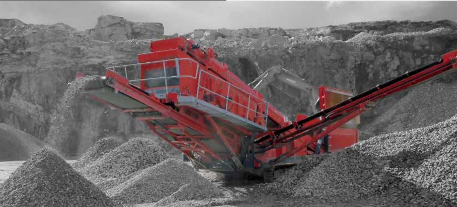
La Finlay® 684 es una máquina compacta y fácil de transportar que permite a los operadores reducir los tiempos de instalación y retirada. La caja de cribado dispone de dos pisos inclinados de 4,3 x 1,7 metros (14' x 5' 7").
