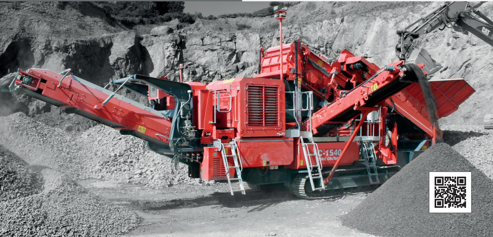
La trituradora móvil de cono sobre orugas Finlay® C-1540 tiene una solvencia contrastada en aplicaciones de minería superficial de menas y áridos. Esta máquina, eficiente y productiva, incorpora la probada trituradora de cono Terex® 1000 con transmisión hidrostática variable directa, liberación automática de material atrapado y ajuste hidráulico de cierre lateral (CSS).
