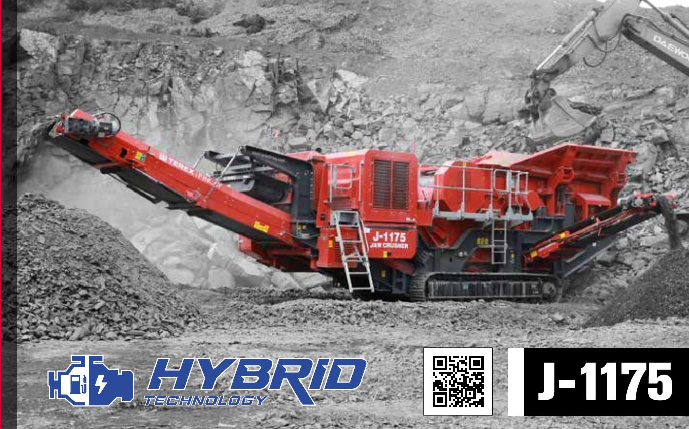
**Le concasseur à mâchoires double motorisation Terex Finlay J-1175 propose à ses utilisateurs toute la souplesse d'une alimentation par raccordement au réseau ou par la configuration de générateur embarqué. Chacune de ces deux options garantissent une puissance significative, tout en permettant de minimiser les coûts d'entretien et de maintenance en comparaison aux machines à motorisation diesel hydraulique.**
